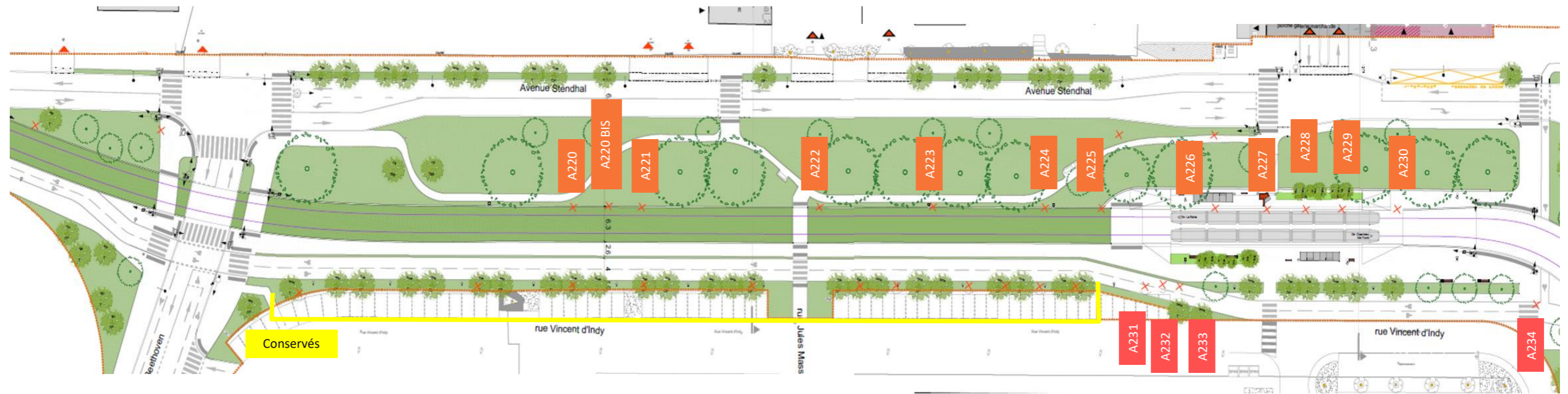
Figure 221 : localisations des arbres à abattre sur l'alignement d'arbres sur l'avenue Stendhal
