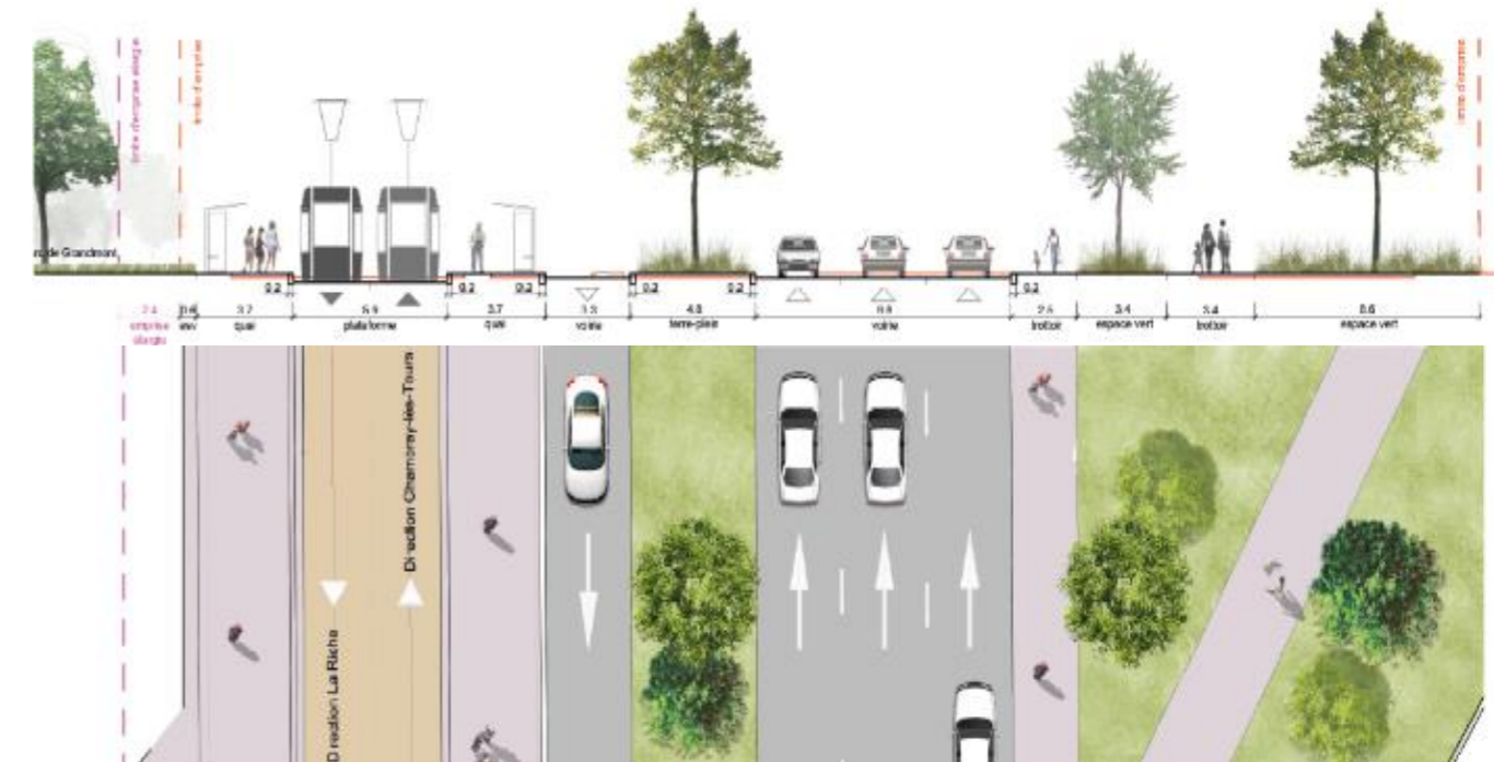
Figure 295 : coupe de principe de l'insertion paysagère sur l'avenue de Bordeaux – Carrefour avec boulevard de Chinon
