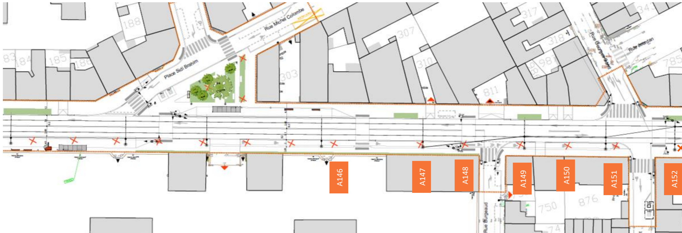
Figure 196 : localisations des arbres à abattre sur l'alignement d'arbres du secteur « boulevard Jean Royer » (section 5)
