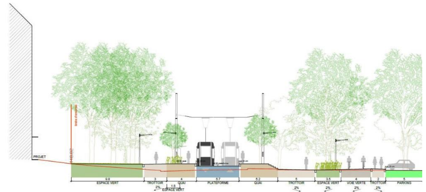
Figure 277 : coupe de principe de l'insertion paysagère sur P+R du Lac
