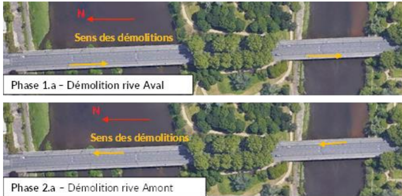
Figure 65 : sens des démolitions des dalles béton sur les ouvrages OA3 et OA4 (Pont Sanitas)
