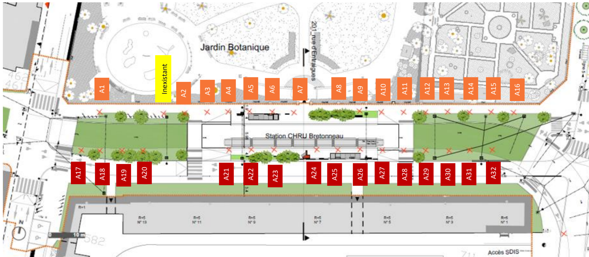
Figure 160 : localisations des arbres à abattre sur l'alignement d'arbres sur le secteur « Jardin Botanique »
