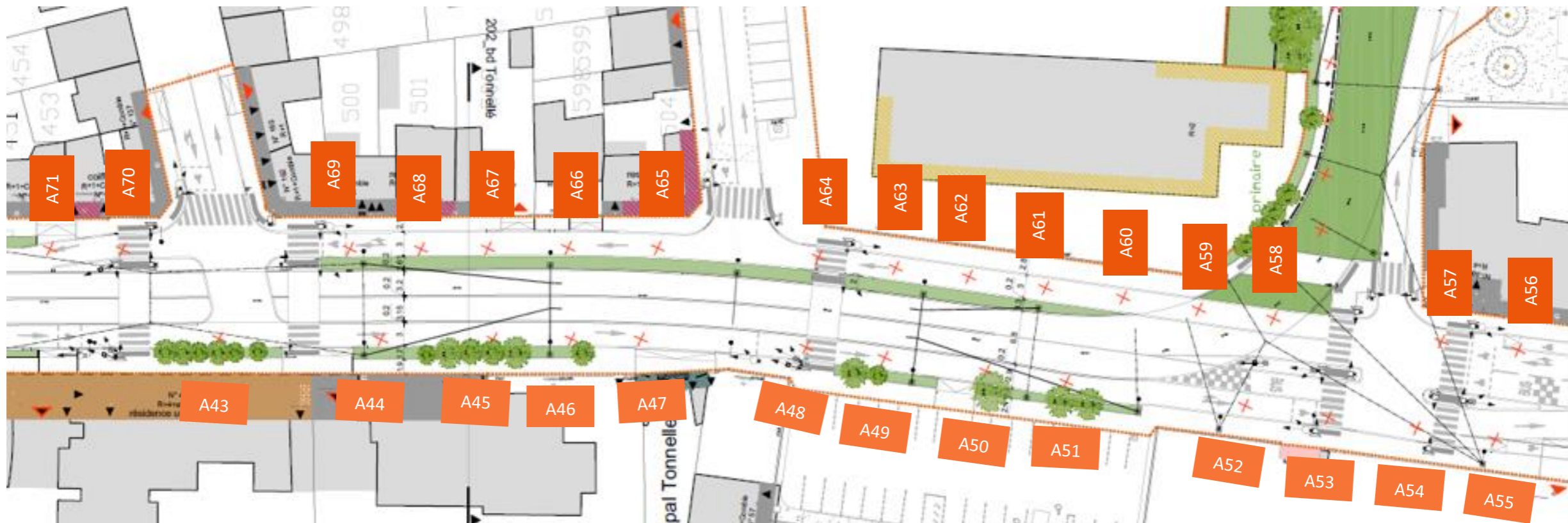
Figure 169 : localisations des arbres à abattre sur l'alignement d'arbres du « boulevard Tonnelé »
