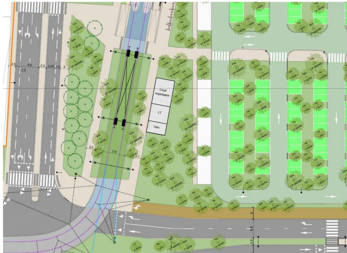
Figure 35 : plan d'insertion du local technique d'exploitation sur le P+R Papoterie
