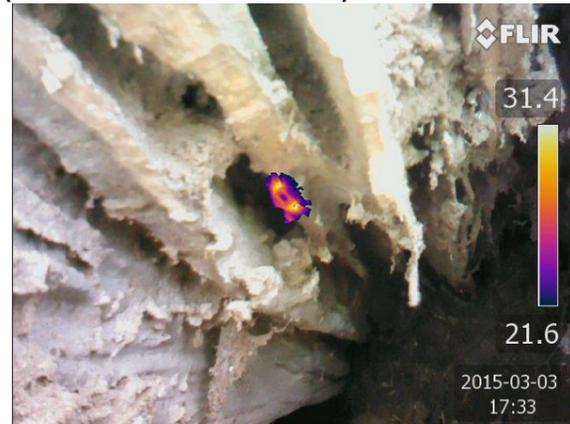
Caméra endoscopique et caméra thermique (source : VNF, 2023)
