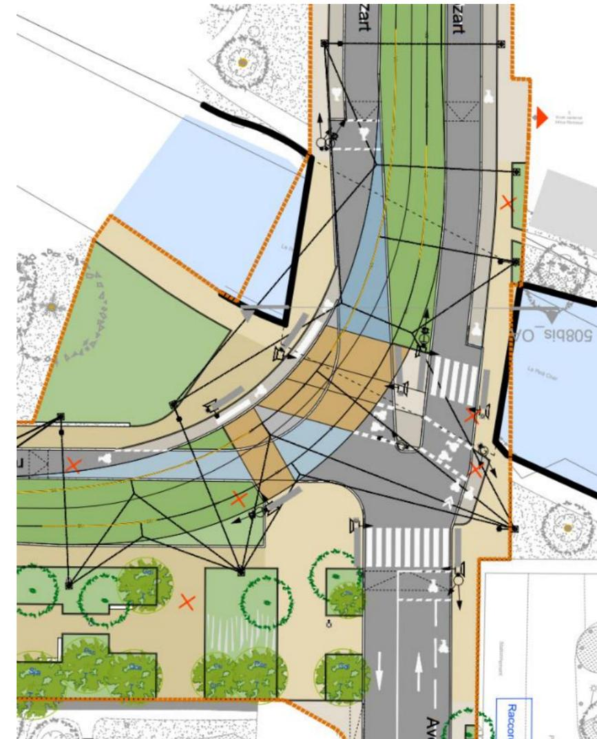
Figure 73 : plan d'insertion de la plateforme tramway sur l'OA6
