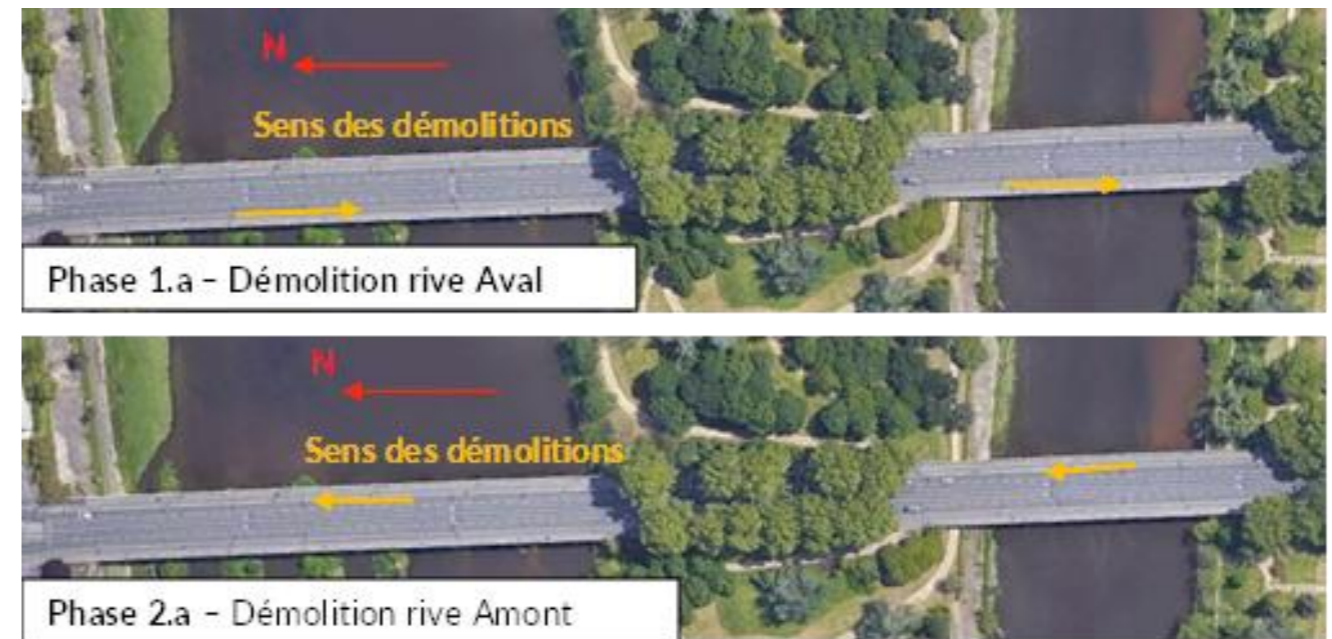
Figure 65 : sens des démolitions des dalles béton sur les ouvrages OA3 et OA4 (Pont Sanitas)
