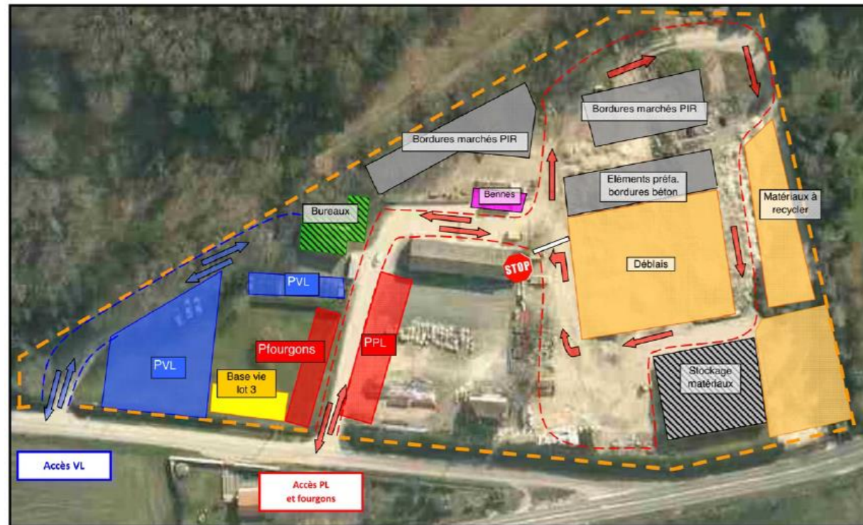
Figure 213 : exemple de base-vie "Entreprise" pour la réalisation de la ligne A
