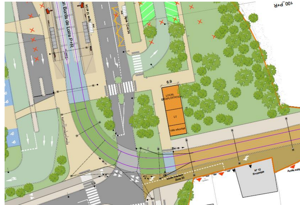
Figure 32 : plan d'insertion du local technique d'exploitation sur le P+R Bords de Loire
